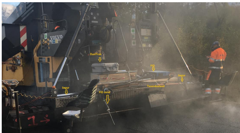
Joonis 64 Mõõtmisprotsess ja analüsaatorid laoturil
