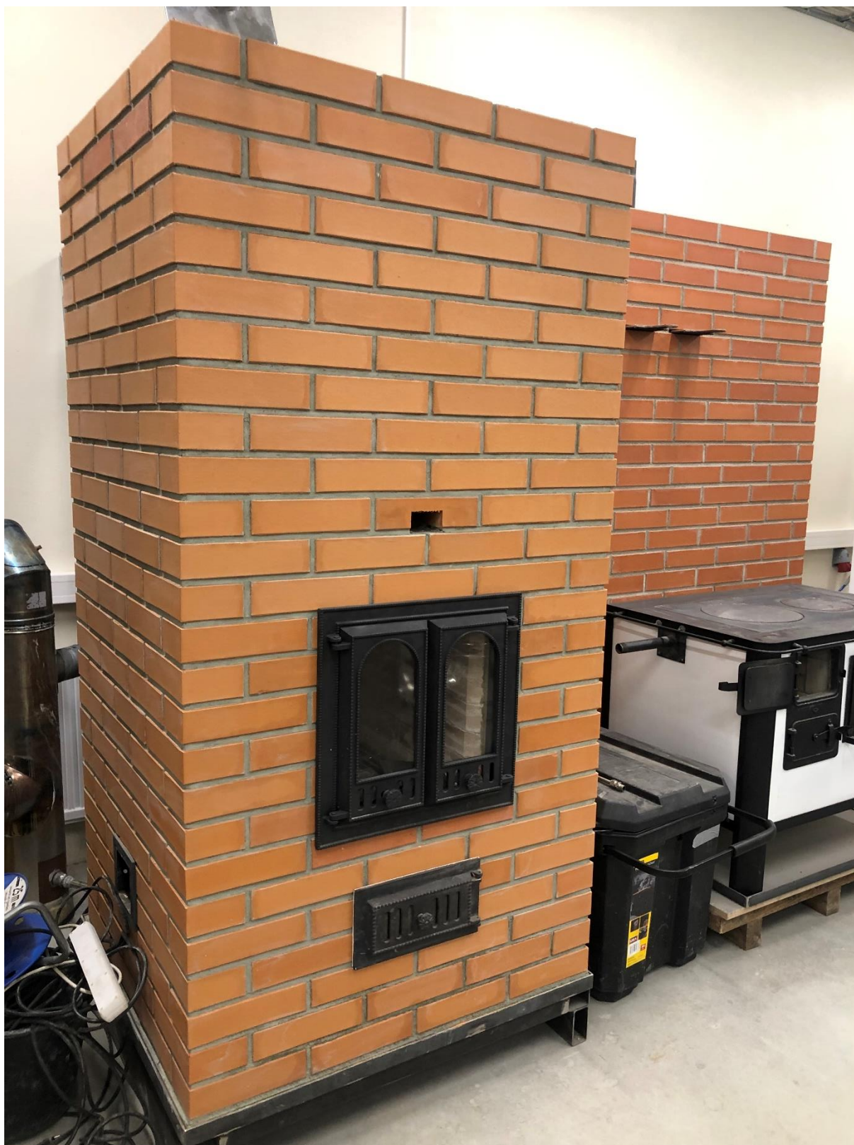
Joonis 9 Soome tüüpi restkoldega ahi
